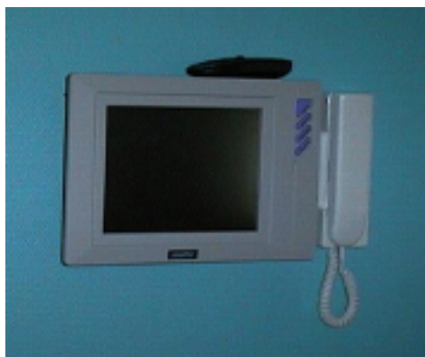
Figur 9. Prototyp av hemenheten (IT-terminal) som skall installeras i lägenheterna inom testbäddarna.
